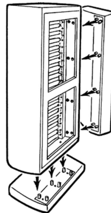
**2.** Die Verbindungen sichern Sie wie abgebildet mit den Flügelschrauben (Unterlegscheiben nicht vergessen).
