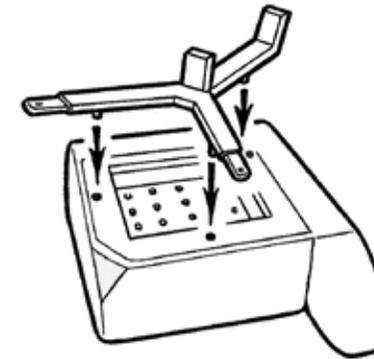
**4.** Schieben Sie die beiden Seitenteile so zum Eckelement, dass die Laschen des Eckelements in die Schlitze der Seitenteile kommen.
