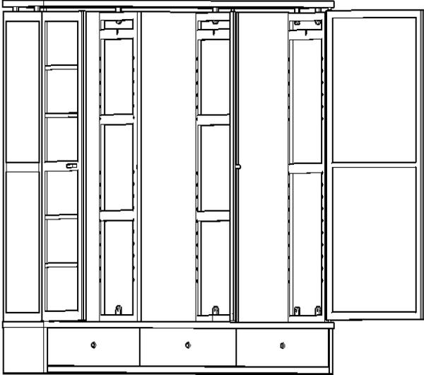
Wenn alle Türen montiert sind, fixieren Sie die Verbindungen zwischen Deckplatte und Seiten- bzw. Innenwänden. Dazu stecken Sie einen Holzstift durch die Lasche und ziehen die Verbindung mit einem Holzspankeil fest.
