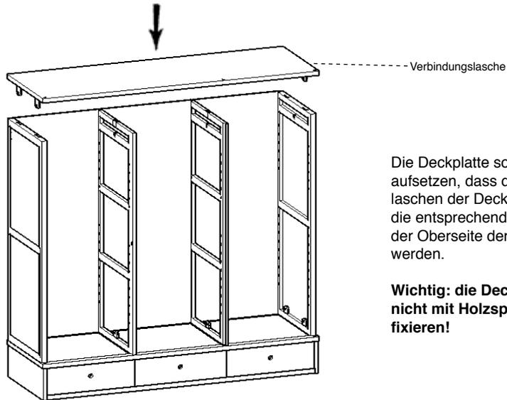
Die Deckplatte so auf die Wände aufsetzen, dass die Verbindungs-laschen der Deckplatte durch die entsprechenden Schlitze an der Oberseite der Wände geführt werden.
