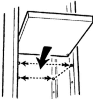
Fachbrett-Träger in gewünschter Höhe in die Bohrungen der Seiten- bzw. Innenwand stecken, Fachbrett einlegen.
