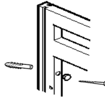
Zur Sicherheit empfehlen wir, den Schrank an der Wand zu befestigen. Dazu findet sich an der Innenwand bzw. an den Seitenwänden des Schrankes hinten oben eine Bohrung, durch die eine Schraube geführt wird. Wanddübel und Schrauben liefern wir mit.
