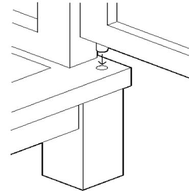
Kippen Sie die Tür oben leicht nach vorne und passen Sie sie unten so ein, dass der Dübel an der Unterseite der Tür in der entsprechenden Bohrung im Einlegeboden einrastet. Dann die Deckplatte oben einige Zentimeter anheben, die Tür wieder ganz vertikal stellen und die angehobene Deckplatte so absenken, dass der Dübel an der Oberseite der Tür in der Bohrung der Deckplatte einrastet.
