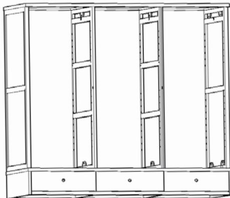
Jetzt sind die Seiten- und Innenwände aufgestellt (unten fixiert), die Rückwände eingebaut und die Deckplatte aufgesetzt (noch nicht fixiert).
